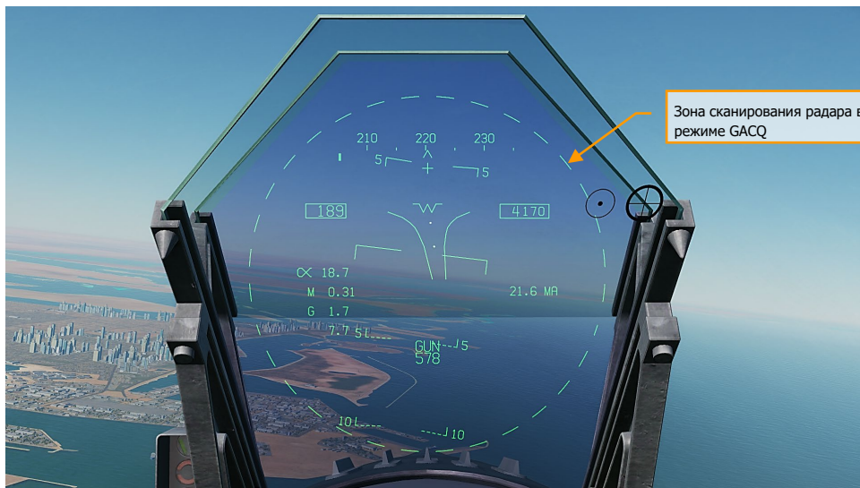
Рисунок 124. Зона сканирования радара в режиме GACQ
