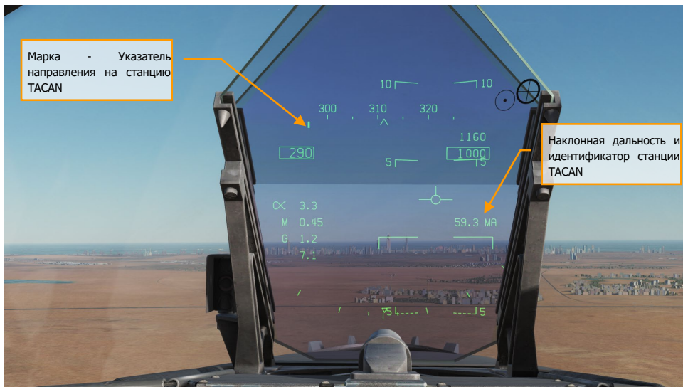
Рисунок 56. Навигационные данные режима TACAN на ИЛС
