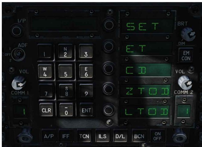
Рисунок 45. Опции TIMEUFC на пульте UFC
