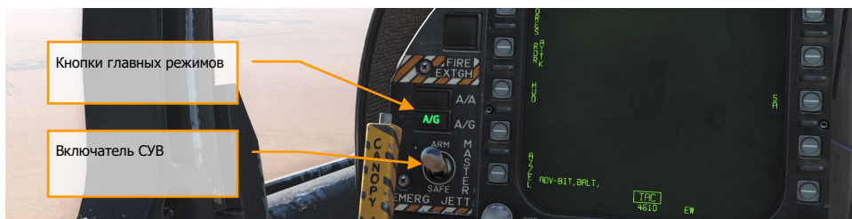
Рисунок 65. Активированный режим A/G (Воздух-Поверхность)
