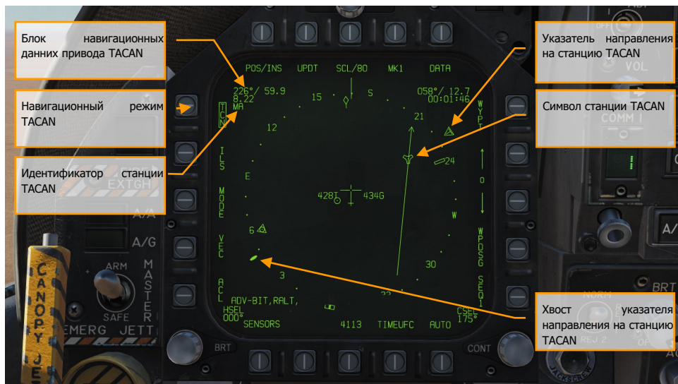
Рисунок 55. Навигационный режим TACAN на HSI
