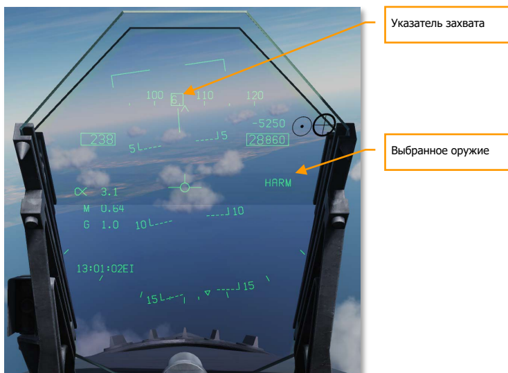
Рисунок 105. Индикация HARM в режиме SP на ИЛС
