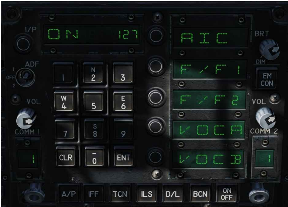
Рисунок 8. Включение терминала MIDS на ПВИ (UFC)
