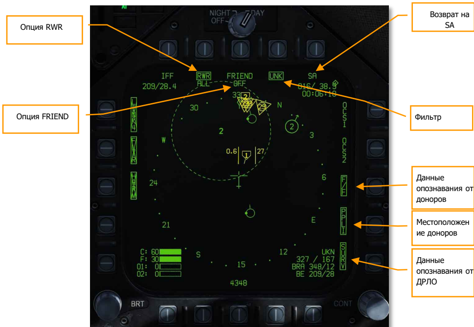
Рисунок 9. Индикация Подстраница Sensor на ситуационном экране
