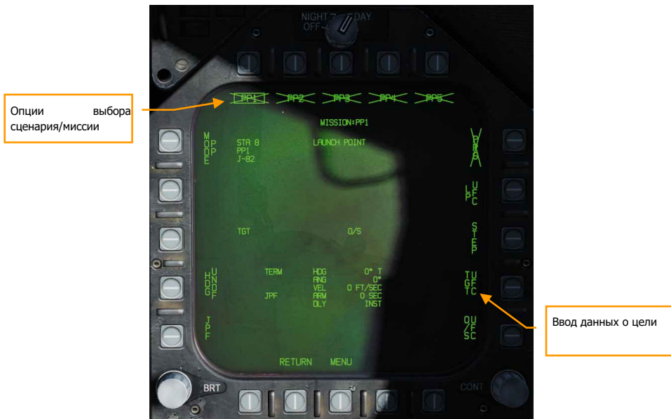
Рисунок 82. Индикация СУВ при выборе GPS вооружения
