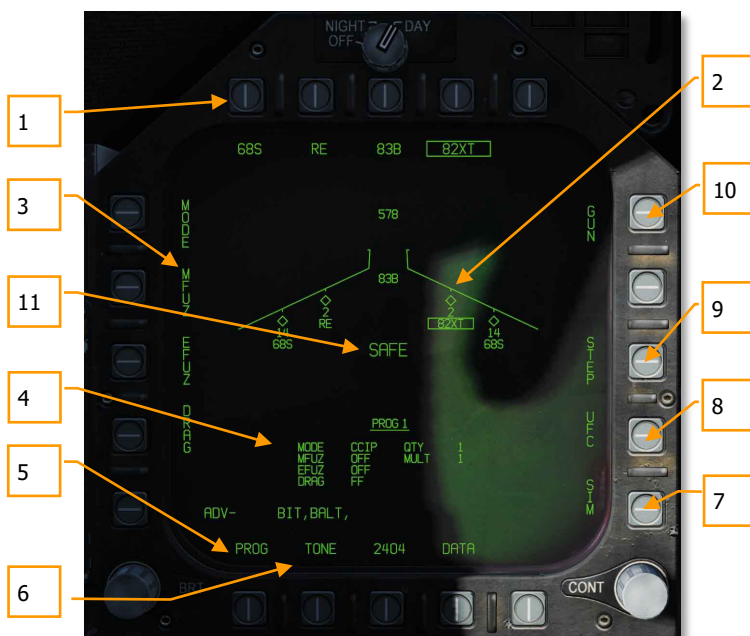
Рисунок 66. Настройка вооружения на странице SMS (STORES) в режиме A/G
