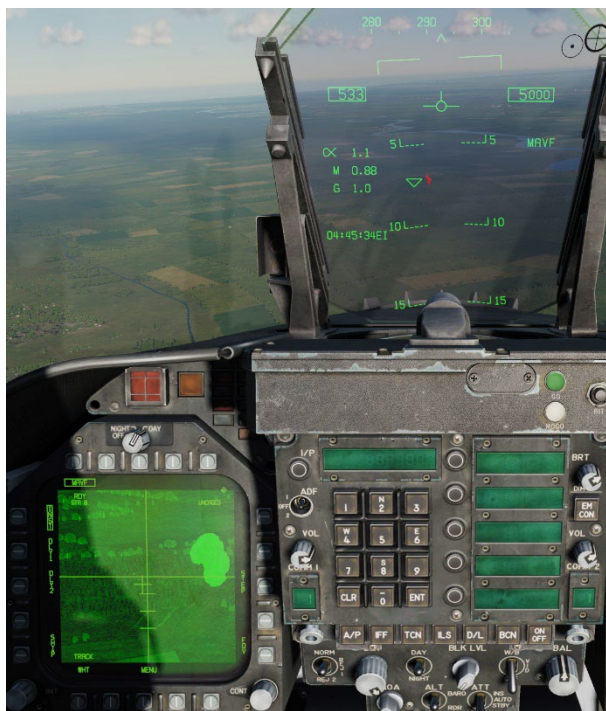
Рисунок 101. Индикация МФД и ИЛС при процедуре стрельбы AGM-65
