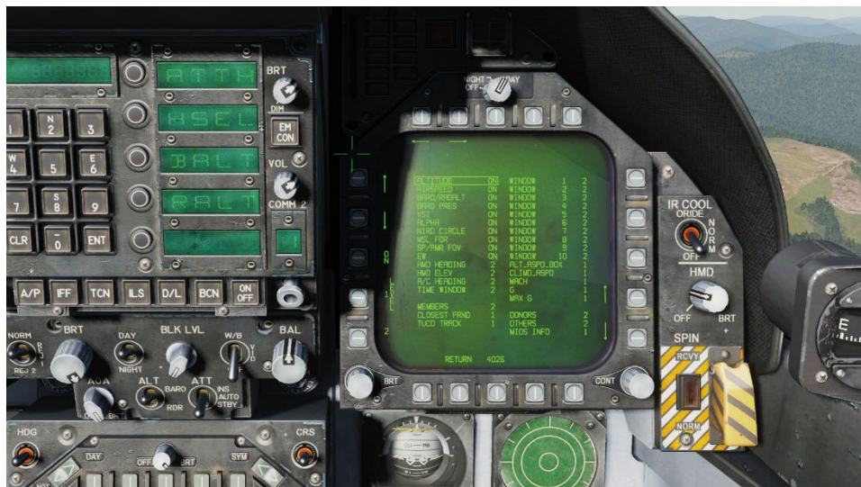
Рисунок 147. Подраздел установок отключения символики нашлемного дисплея
