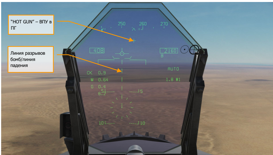
Рисунок 70. Индикация режима AUTO на ИЛС без ЦУ, угол пикирования &lt;7.5
