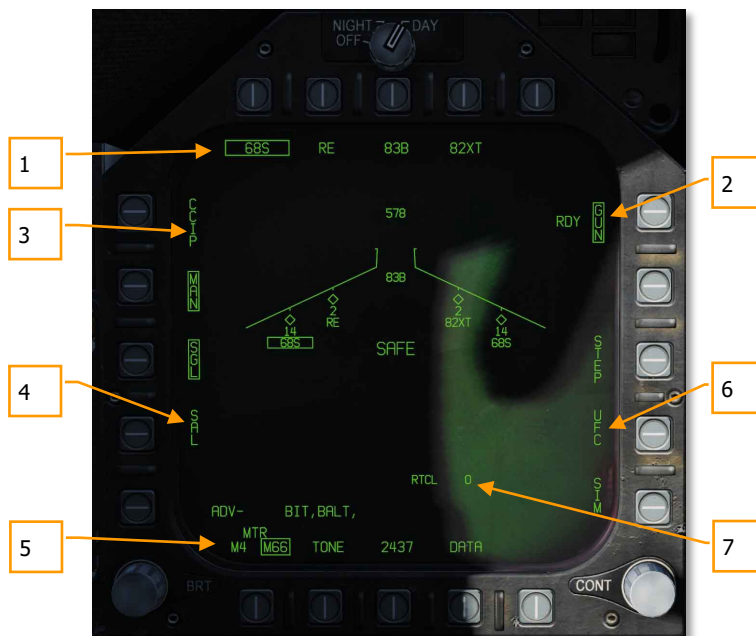
Рисунок 89. Индикация экрана СУВ при стрельбе НАРами
